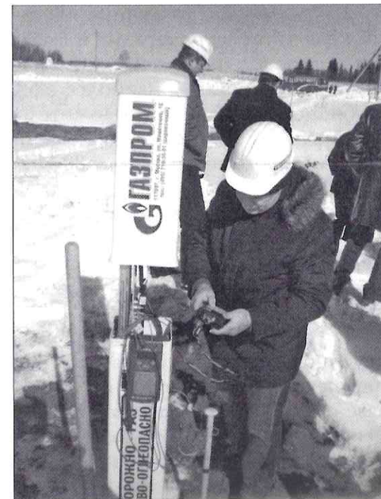
Рис. 3.40. Испытания анодного заземления из протяженного гибкого анода
