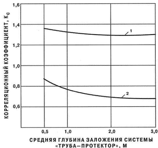
Рис. 4.38. График зависимости K_c = f(\gamma) ; \dot{H} для 0,5 \leq C \leq 6,7 : 1 — максимальные значения; 2 — минимальные значения
