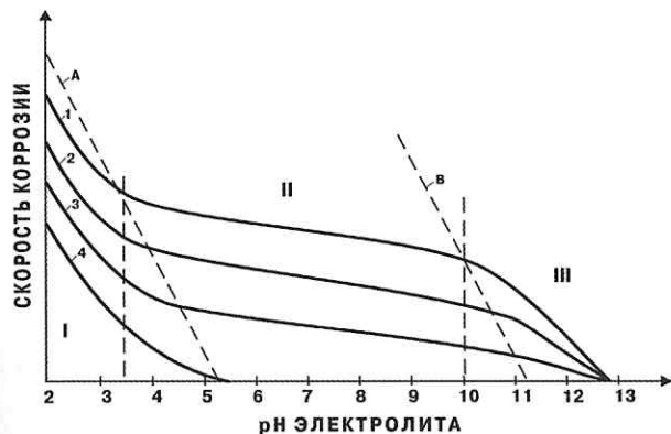
Рис. 1.12. Зависимость изменения скорости коррозии от рН электролитической среды и содержания в ней кислорода:
