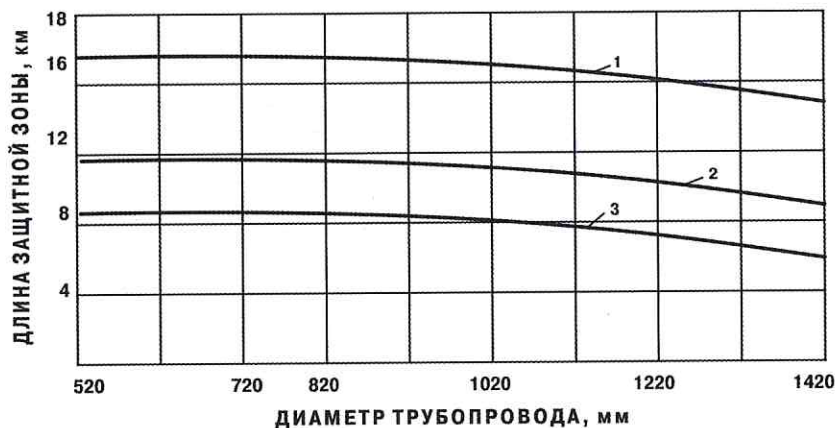
Рис. 5.19. Расчетная длина защитной зоны установок катодной защиты при потенциале в точке дренажа 2,0 В:
