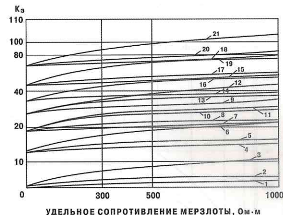
Рис. 3.5. Коэффициент сопротивления растеканию единичного электрода в грунтах различного удельного сопротивления при изменении глубины их промерзания: 1, 4, 7, 10, 13, 16, 19 — глубина промерзания 2 м; 2, 5, 8, 11, 14, 17, 20 — то же 3 м; 3, 6, 9, 12, 15, 18, 21 — то же 4 м; 1, 2, 3 — \rho_T = 10 \text{ Ом}\cdot\text{м} ; 4, 5, 6 — \rho_T = 20 \text{ Ом}\cdot\text{м} ; 7, 8, 9 — \rho_T = 30 \text{ Ом}\cdot\text{м} ; 10, 11, 12 — \rho_T = 40 \text{ Ом}\cdot\text{м} ; 13, 14, 15 — \rho_T = 50 \text{ Ом}\cdot\text{м} ; 16, 17, 18 — \rho_T = 70 \text{ Ом}\cdot\text{м} ; 19, 20, 21 — \rho_T = 100 \text{ Ом}\cdot\text{м}
